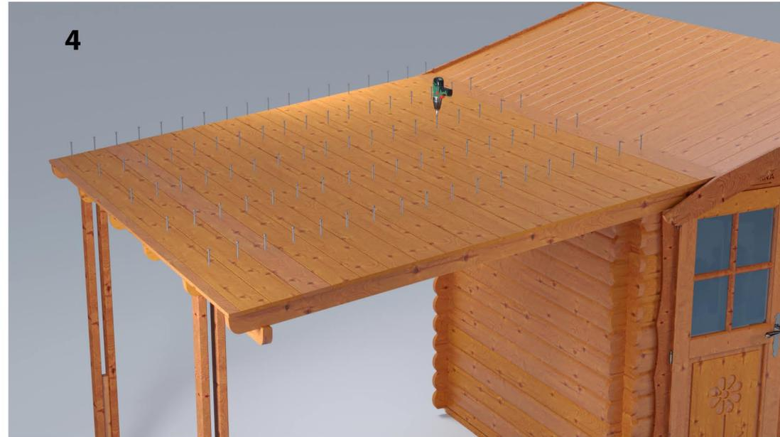
Fissaggio delle perline di copertura.
