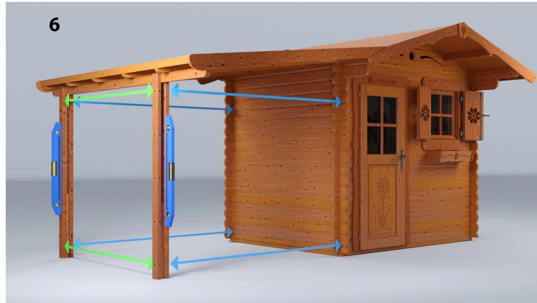
Verificare che le misure in prossimità del terreno corrispondano a quelle delle parti sotto la copertura. Messa in "bolla" delle colonne. Fissare le colonne a terra con delle staffe o scegliere una tipologia di ancoraggio in base al terreno sottostante la struttura.
