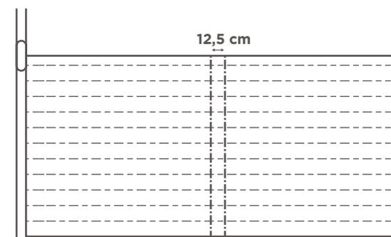
Tracciare, in posizione centrale, una linea perpendicolare alla linea di colmo, successivamente tracciarne una parallela a **12,5 cm** di distanza
