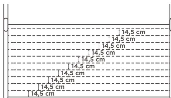
Dopo aver accertato che la superficie di posa sia perfettamente liscia e asciutta, tracciare delle linee parallele a **14,5 cm** di distanza una dall'altra, fino alla linea di colmo.
