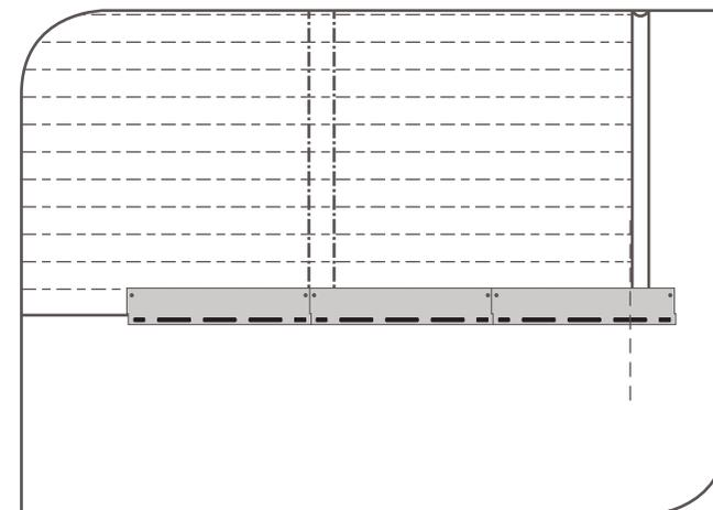
Una volta completata la prima fila, passare alla seconda (non rimuovere le faldine). Allineare la prima tegola alla seconda linea verticale.
