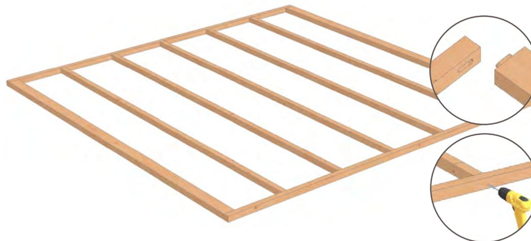
STESURA E FISSAGGIO DELLA STRUTTURA DEL PAVIMENTO
