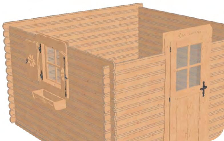
Inserite eventuali finestre e fissate le fioriere (se presenti) con le viti 4x40mm. Poi proseguite con il montaggio delle pareti
