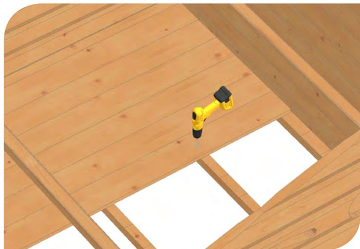
Posare le perline del pavimento issandole con viti 4x40
