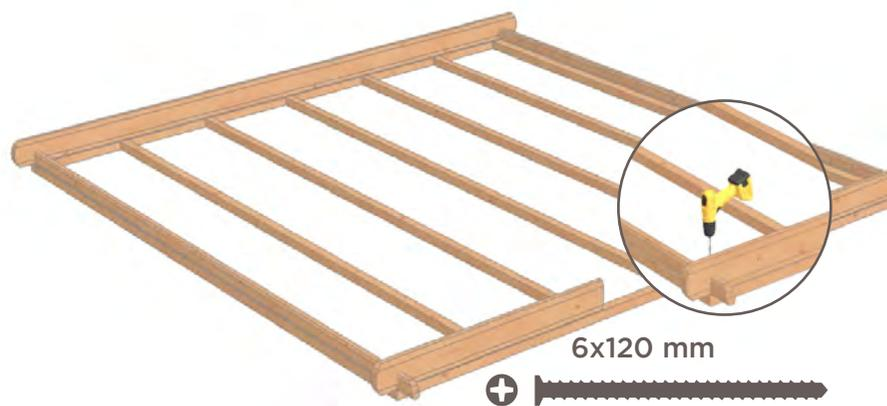
Incastrare il primo giro di tavole e fissarlo (dopo aver preforato) con viti 6x120 al telaio del pavimento nei 4 angoli
