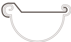
Sezione della grondaia con la staffa montata
